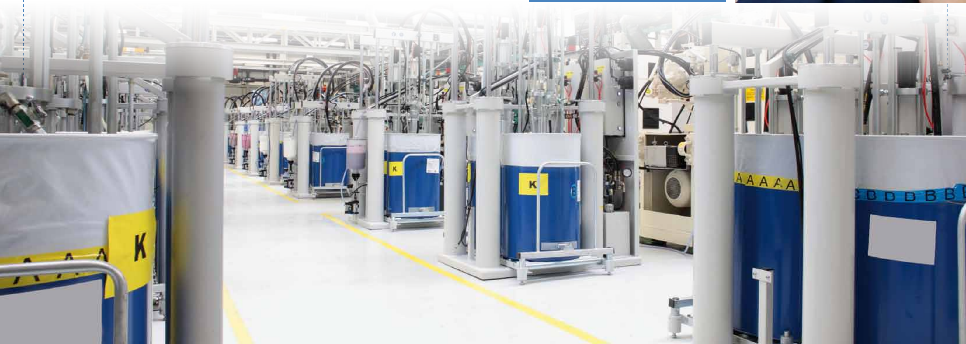
Новая пневмостанция снабжает сжатым воздухом автоматы литья под давлением для производства силиконовых уплотнителей
